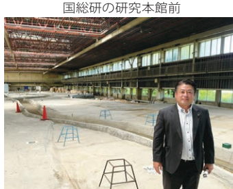
水害が起きた河川を1/30スケールで再現し、堤防の高さなどが研究されている
